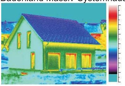
Keine Wärmebrücken im gesamten Fassadenbereich. Lediglich Wärmestau unter dem Dachvorsprung durch Abwärme der Fenster (Schirmeffekt) Einziger Schwachpunk sind trotz Einsatz von hochwertigen 5-Kammerprofilen, die Fensterrahmen. Diese hervorragend gedämmte Gebäudehülle sorgt für eine erhebliche Reduzierung der Heizkosten und verhindert Pilzund Schimmelbildung. Geringe Heizkosten und hohe Wertbeständigkeit durch innovatives
